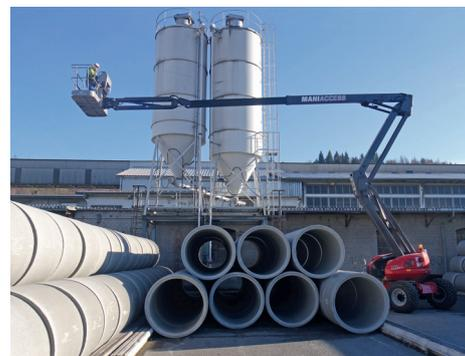
ebenem Untergrund. Die Allradlenkung mit ihren drei Lenkkarten sorgt für Wendigkeit und zudem lässt sich der Arbeitskorb um 90° nach rechts und links schwenken. Damit und mit der grossen seitlichen Reichweite ist jede Ecke der Halle erreichbar. Nicht einmal die Maschine muss hierzu bewegt werden, was viel Zeit spart. Urs Helfenberger bestätigt:
