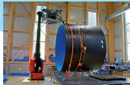
Grossvolumige Kunststoffelemente verlangen nach Höhenarbeiten, die mit der 100 VJR besser und sicherer gelingen
