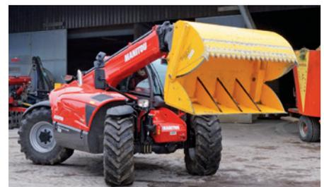
Die Siloschneidschaufel passt auf die Manitou-Werkzeugaufnahme und verriegelt hydraulisch
