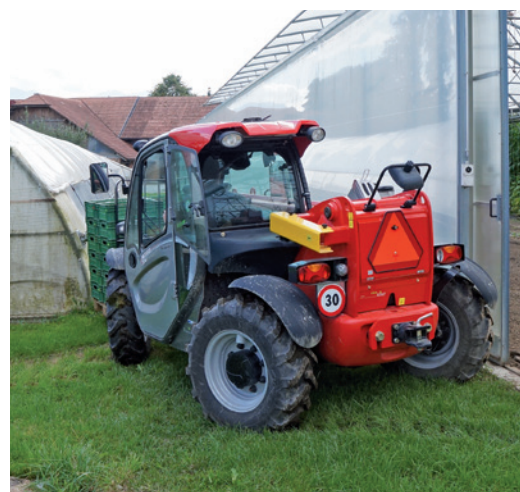
Vierradlenkung und kompakte Masse sorgen für die nötige Wendigkeit auf dem Gelände des Biohofs
