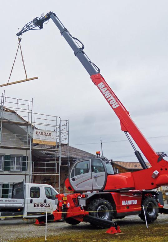
Die 3-in-1 Maschine Manitou MRT 2550 dient der Jean Barras Sàrl als Teleskoplader, Kran und Arbeitsbühne
