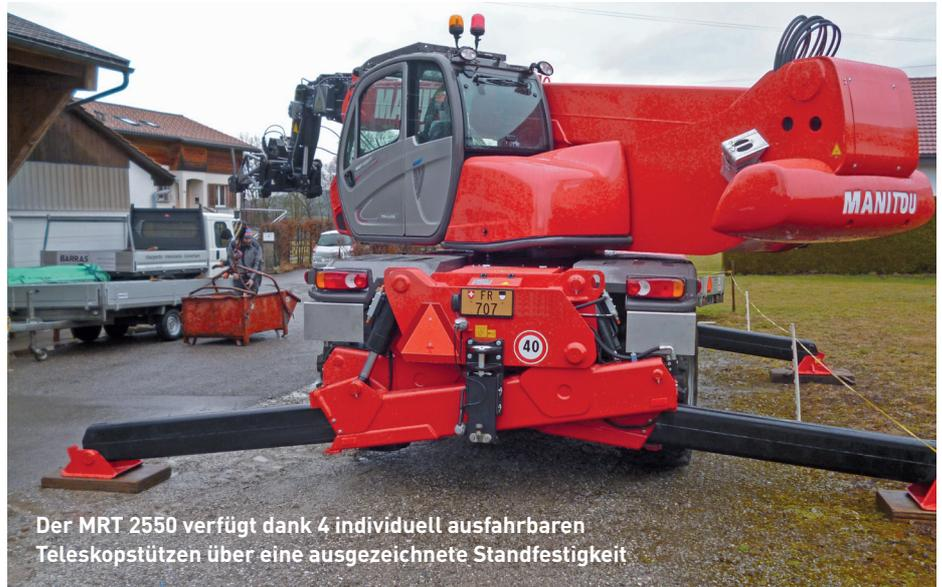
Der MRT 2550 verfügt dank 4 individuell ausfahrbaren Teleskopstützen über eine ausgezeichnete Standfestigkeit
