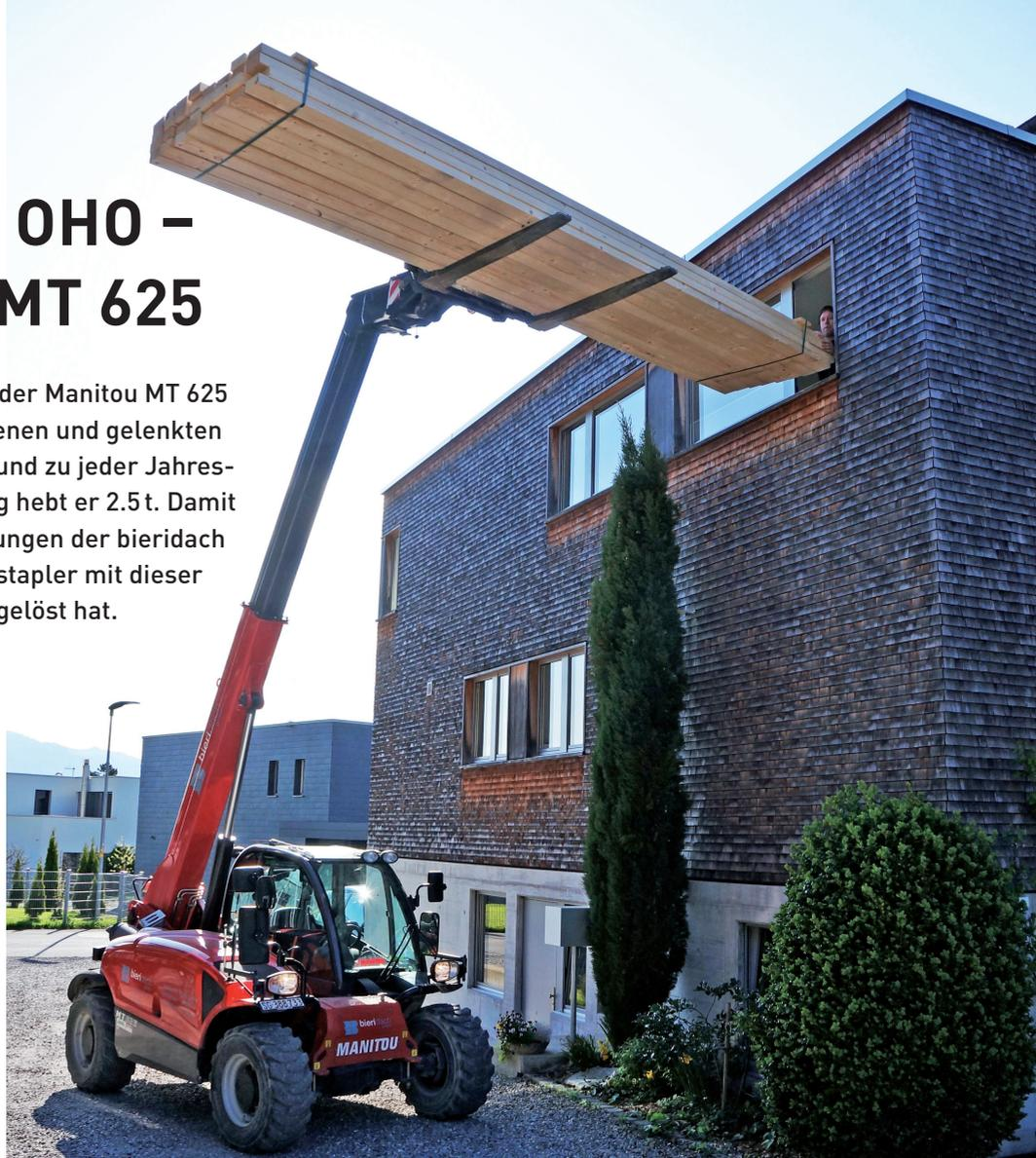
Lastwagens und er hebt die tendenziell immer grösser werdenden Verpackungen dank seiner 2.5 t Tragkraft in einem Stück. Mühselige Umladearbeiten zur Gewichtsreduktion eines Paletts entfallen gänzlich. Im Gegenteil, der Manitou hebt das Palett zur bequemen Materialentnahme auch gleich in die Höhe vor eine Gebäudeöffnung.
