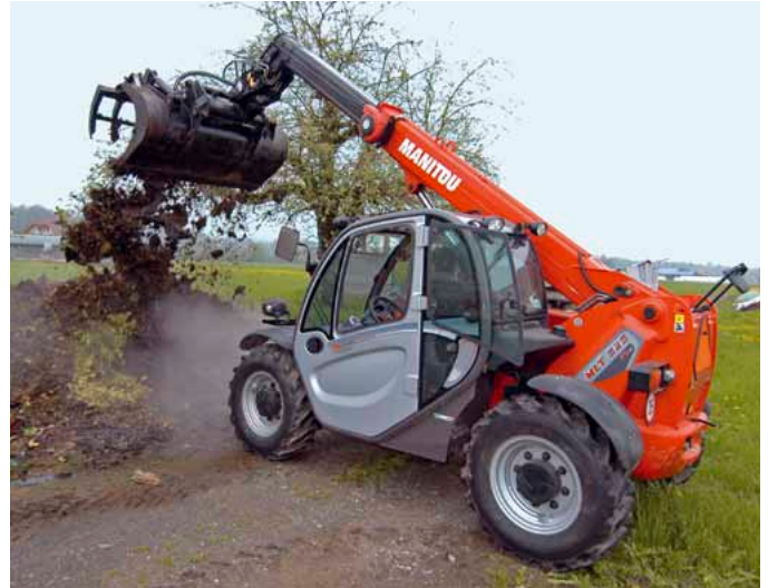
Der Teleskoplader Manitou MLT 625 in Aktion mit der Mistgreifzange.
