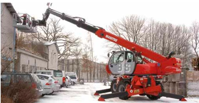
Mit der Arbeitsbühne können mit dem Manitou MRT 2540 bis auf 25 Meter Höhe Solaranlagen und Spenglerarbeiten kontrolliert und ausgeführt werden.
