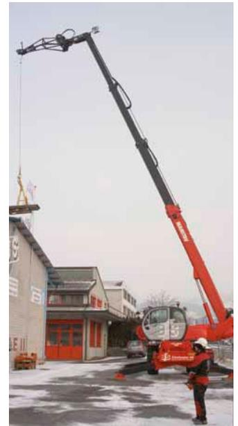
Mit Gittermast und Seilwinde ist der Manitou der ideale Kranersatz.
