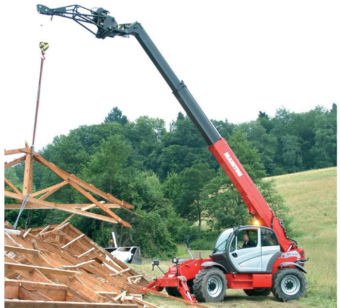
Dank der Reichweite von über 14 m stellt das Abheben des Dachstuhls den Teleskoplader Manitou MT 1436 vor keine Probleme.
