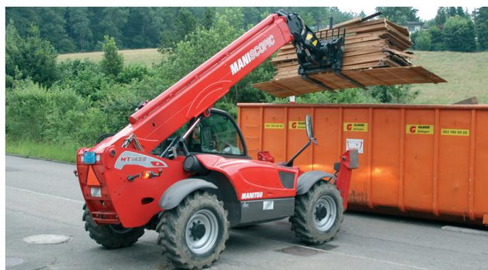
Mit dem Manitou werden die sortierten Abbruchmaterialien in Container geladen.
