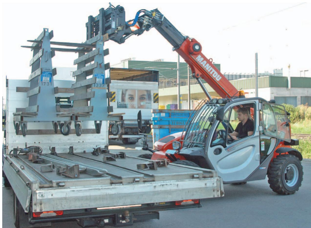
Die Zinken müssen wegen den verschiedenen grossen Transportböcken verstellbar sein, was beim Manitou MT 625 dank dem raffinierten JSM-Joystick direkt von der Kabine aus möglich ist. (Bilder: Manitou)
