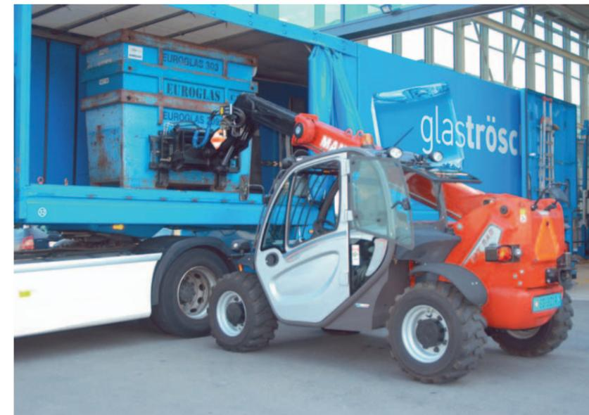
Dank der Reichweite von 3,40 Metern und der Hubhöhe von 5,85 Metern kann der Lastwagen mit dem Manitou MT 625 von einer Seite aus präzise und rationell be- und entladen werden.
