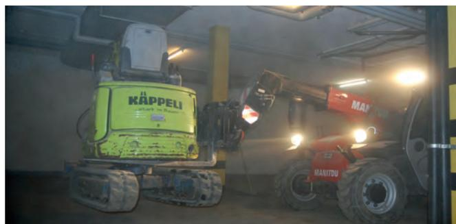
*Mit der Hubkraft von 2.5 Tonnen können mit der Gabel sogar Raupenbagger transportiert werden*
