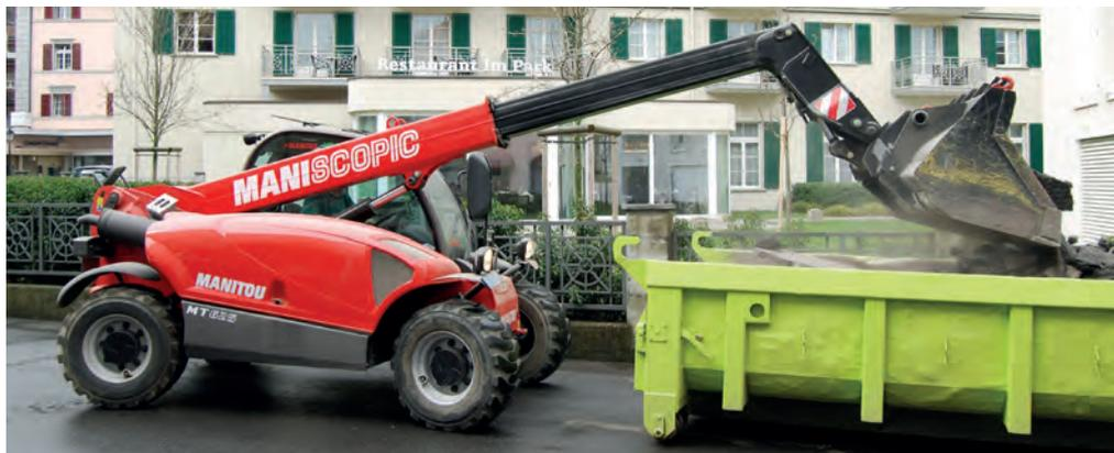
*Dank dem 3.4 Meter Teleskoparm ist das Abladen und Verteilen von Hinten kein Problem*
