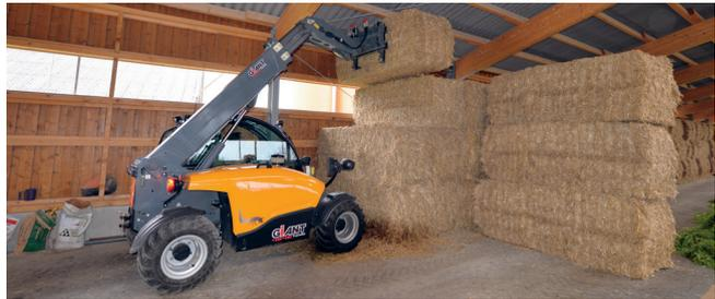
Stapeln mit Ballenspitze und durchgehender Hubkraft von 1'450 Kg
