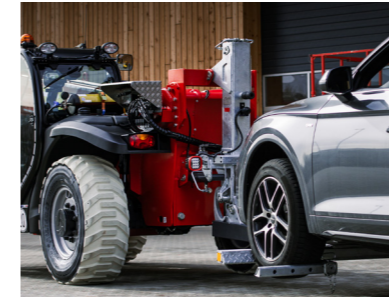
Hydraulische Abschleppbrille Havarierte PKW hydraulisch aufnehmen.
