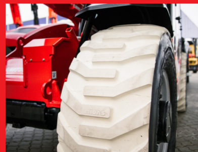
Nicht-markierende Spezialbereifung Spurenfreies Fahren in der eigenen Wache.
