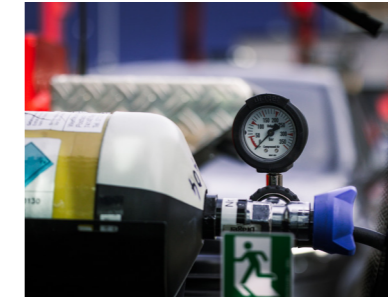
Autarker Atemschutz Druckluftflasche und Atemregler-Halterung fest integriert.
