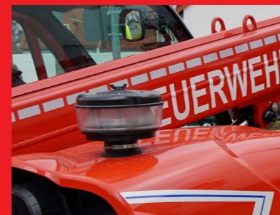
Vorluftfilter Saubere Kabinenluft bei extremer Staubbelastung.
