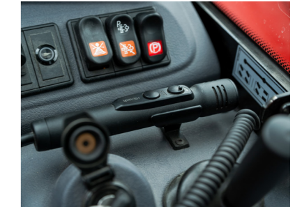
Kommunikation BOS Funk "Push to talk" & Freisprechanlage.
