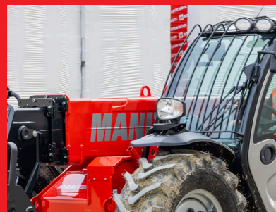
Frontscheibenschutz Stahlgitter zum Schutz der Besatzung vor mechanischen Einwirkungen.
