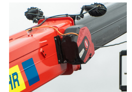
Kabeltrommel Flexible Stromversorgung mit robuster Führung für den Außeneinsatz.
