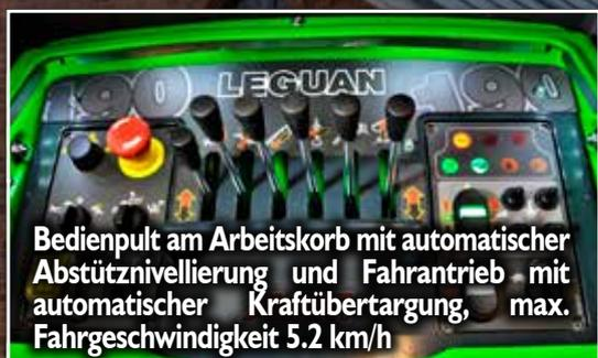
**Bedienpult am Arbeitskorb mit automatischer Abstütznivellierung und Fahrtrieb mit automatischer Kraftübertragung, max. Fahrgeschwindigkeit 5.2 km/h**
