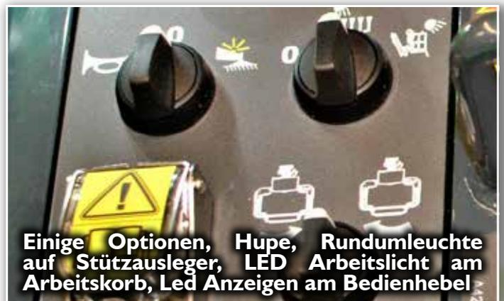
Einige Optionen, Hupe, Rundumleuchte auf Stützausleger, LED Arbeitslicht am Arbeitskorb, Led Anzeigen am Bedienebel
