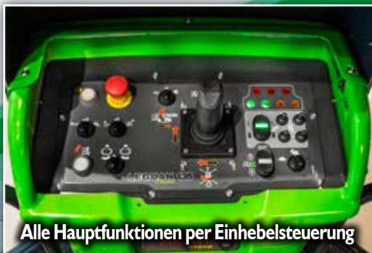
Alle Hauptfunktionen per Einhebelsteuerung
